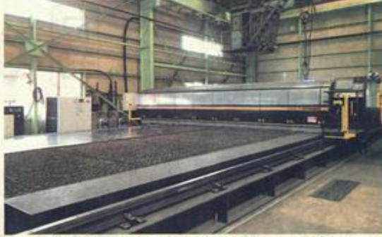
増設した日酸TANAKA製の出力6キロワットファイバーレーザー切断機「FMR II-TF6000」
