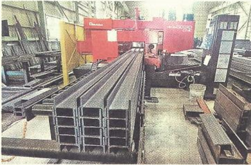
新設したバンドソーで長尺素材を高速で「束ね切断」し、加工の品質精度も向上
