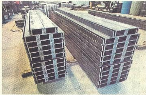
新設したバンドソーで長尺素材を高速で「束ね切断」し、加工の品質精度も向上
